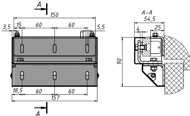
Рисунок 2 - Габаритный чертеж комплекта МК 150-IN
